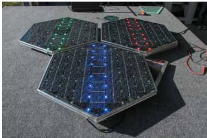
Пример комбинирования различных гелиоэлементов (фото: Scott & Julie Brusaw)
