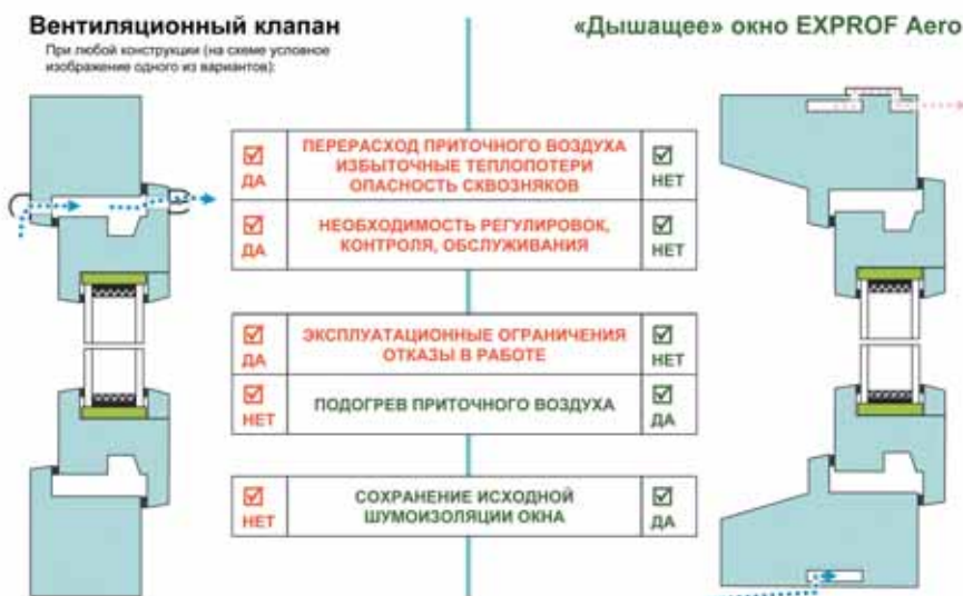
Сравнение окна с вентиляционным клапаном и «дышащего» окна EXPROF Aero
