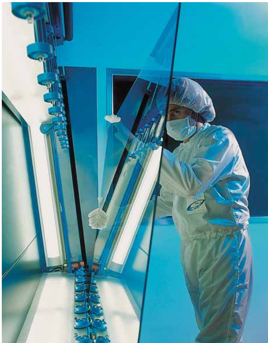
Контроль качества: Фирма Econtrol-Glas производит функциональное стекло с электрическим затемнением, способное отражать до 90% солнечных лучей. Фото: Econtrol-Glas
