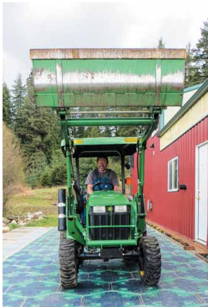
Скотт и Джулия Брюсов (Scott & Julie Brusaw) тестировали разработку «Solar Roadways» у себя дома при помощи трактора (фото: Scott & Julie Brusaw)
