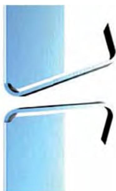
**Рис. 4. Панели в разрезе (нижний и верхний борт)**
