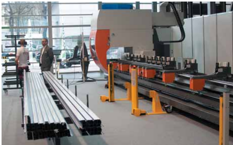
Производственный участок подготовки профиля – обработка оконных створок
