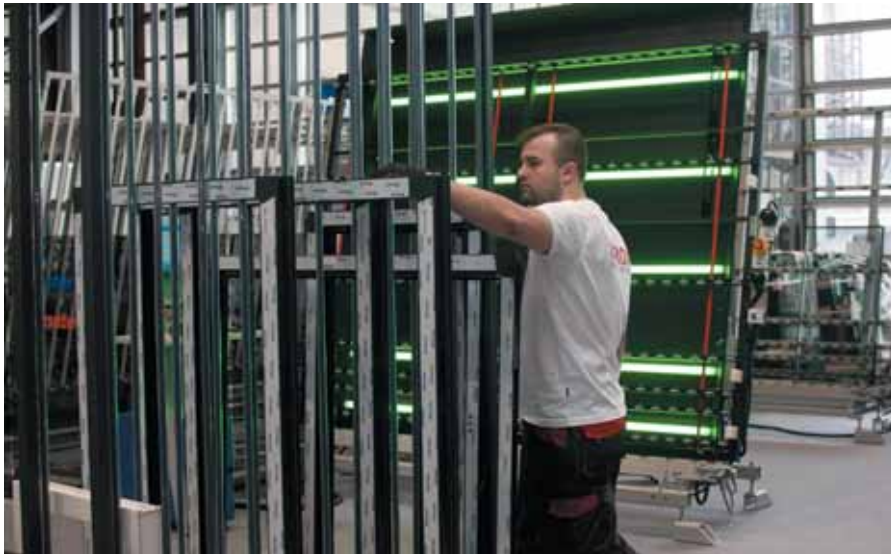
Подготовка полуфабрикатов окон к остеклению
