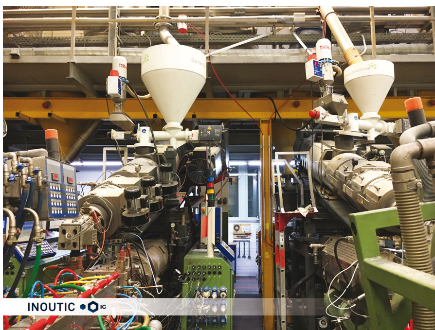
Коэкструзионные установки с новыми коэкструдерами в наспинном расположении, эксплуатируемые на заводе компании «Inoutic» в г. Боген (фотография: © Inoutic)
