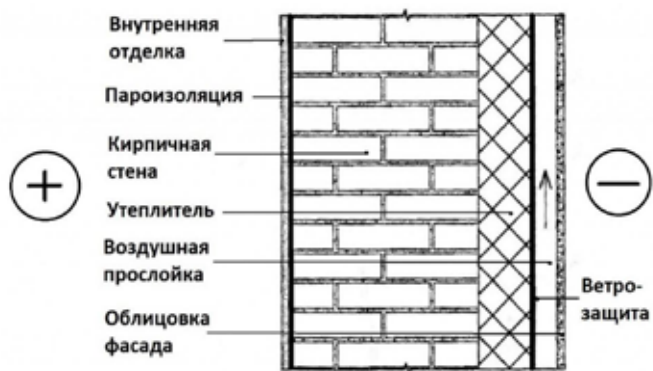
Рис. 3. Эффективная схема утепления наружной стены снаружи
