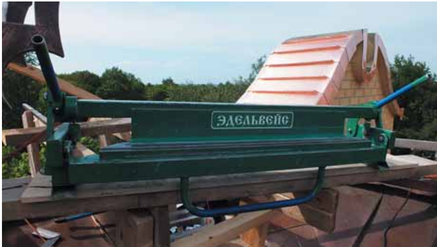
Изготовление деталей для защиты фасадов здания производилось также на сегментном станке марки Эдельвейс производства города Россошь (Воронежская губерния), патент № 98702, Н.А. Савченко от 2010 года
