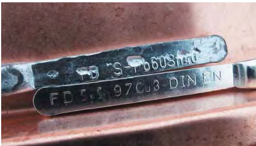
Стержни припоя двух типов – для меди (97% свинца и 3% меди) и титан-цинка (40% свинца и 60% олова)
