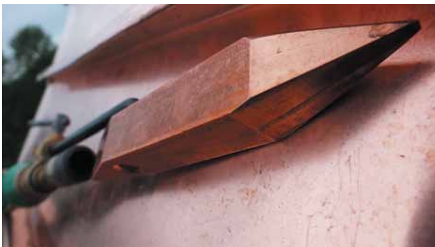
Медная насадка PERKEO весом 350 грамм игольчатого типа для низкотемпературной пайки в труднодоступных и угловых местах на кровле
