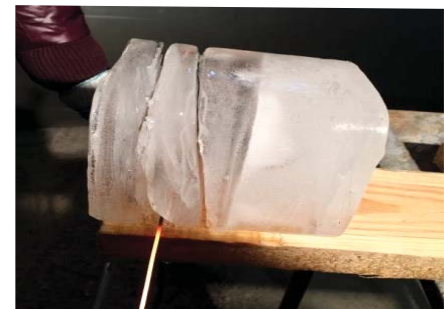
Рис. 10. Резка нихромовым нагревателем
