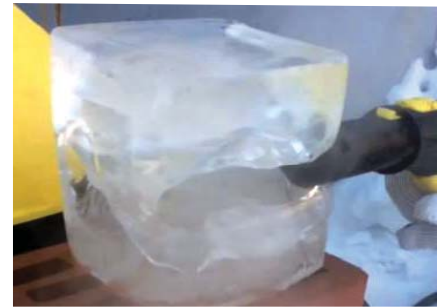
Рис. 9. Резка парогенератором Karcher sc 2
