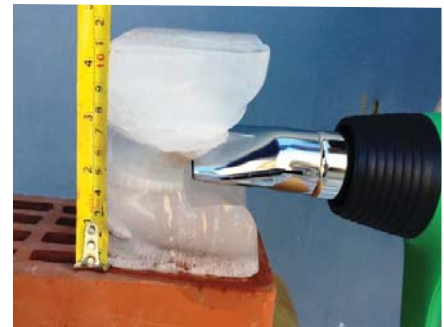
Рис. 10. Резка строительным феном Hitachi RH 600 T
