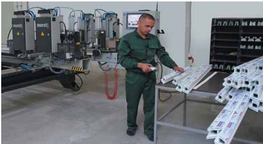
Управление процессом сварки при помощи штрихкодов, генерированных программой WH OKNA
