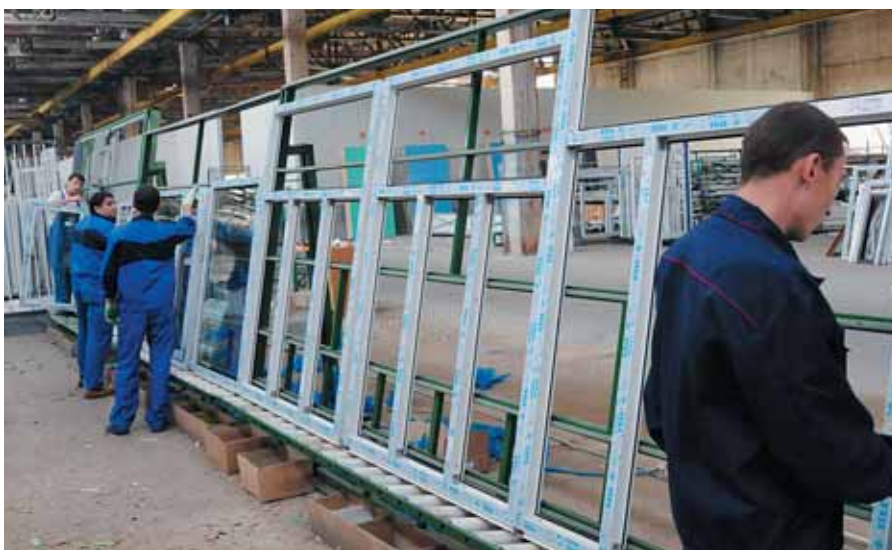
Удлиненный стенд остекления, позволяющий организовать пооперационный конвейер при остеклении
