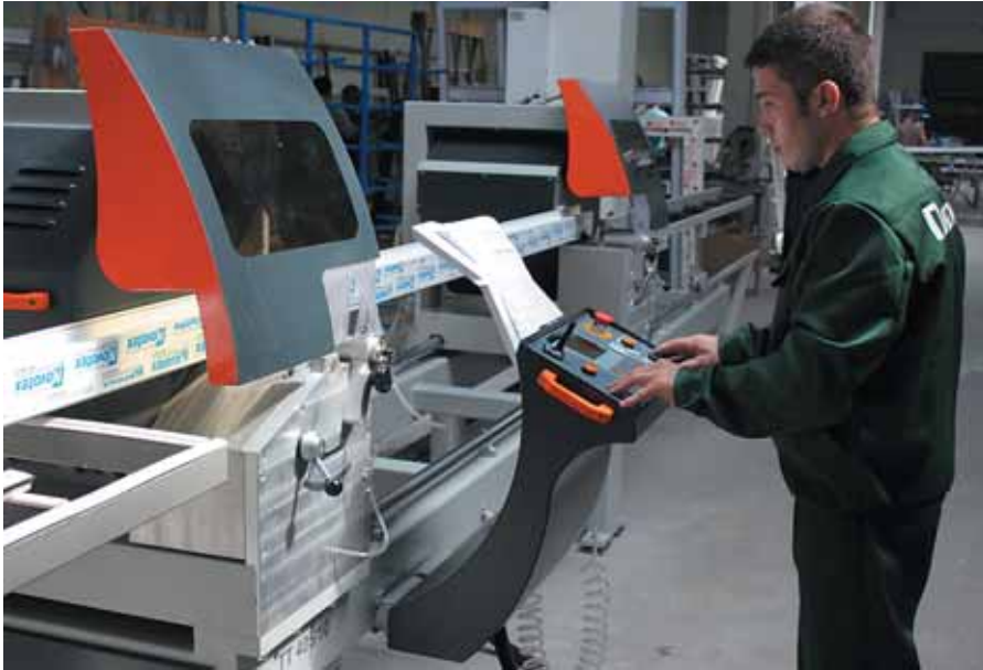
Раскрой профиля из ПВХ на основе оптимизации, созданной в программе WH OKNA
