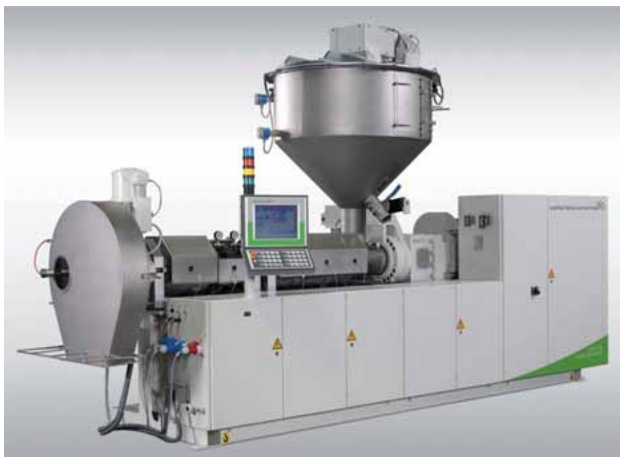
Экструдер компании «battenfeld-cincinnati» для получения гранулята
