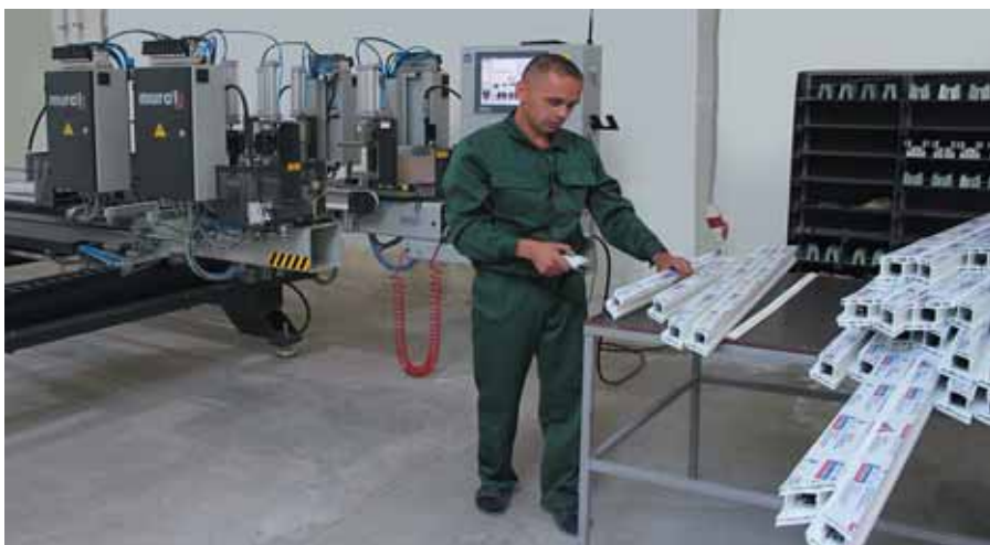
Управление процессом сварки при помощи штрихкодов, генерированных программой WH ОКНА
