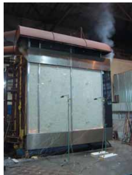
Ненесущая навесная светопрозрачная конструкция (фасад) с каркасом из стальных профилей и заполнением из пожаростойкого стекла в составе стеклопакета.
