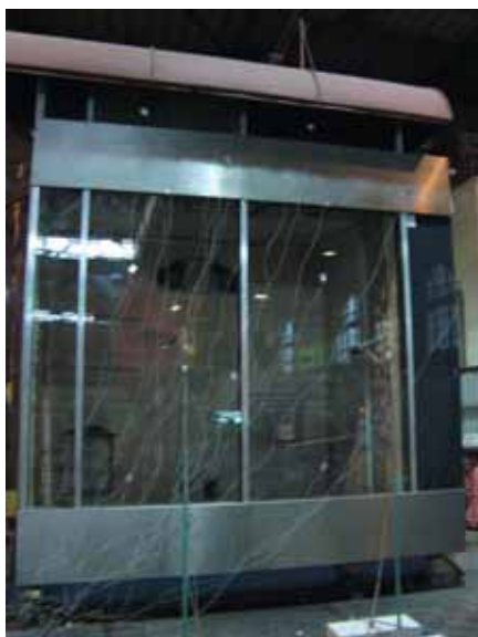
Ненесущая навесная светопрозрачная конструкция (фасад) с каркасом из стальных профилей и заполнением из пожаростойкого стекла в составе стеклопакета.
