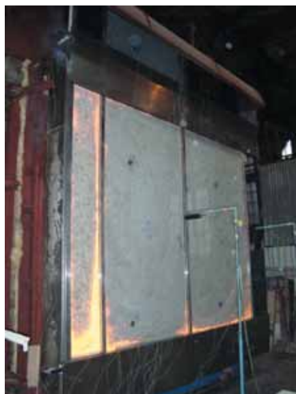
Ненесущая навесная светопрозрачная конструкция (фасад) с каркасом из стальных профилей и заполнением из пожаростойкого стекла в составе стеклопакета.
