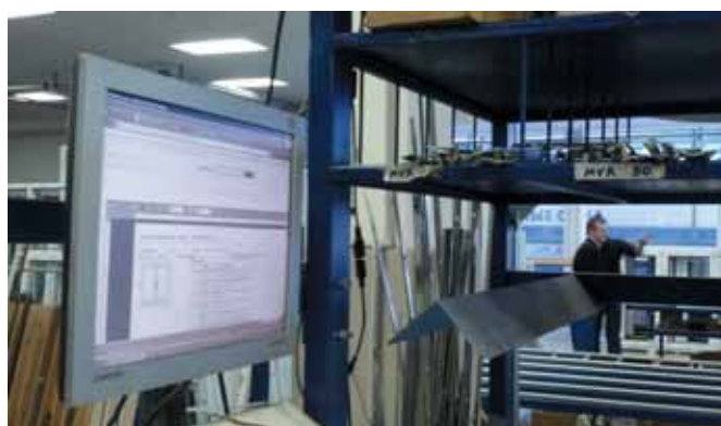
Рабочее место для установки фурнитуры с использованием модуля WH Net и стола WHK-2300
