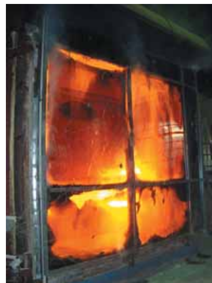
Несущая навесная светопрозрачная конструкция (фасад) с каркасом из стальных профилей и заполнением из пожаростойкого стекла в составе стеклопакета.
