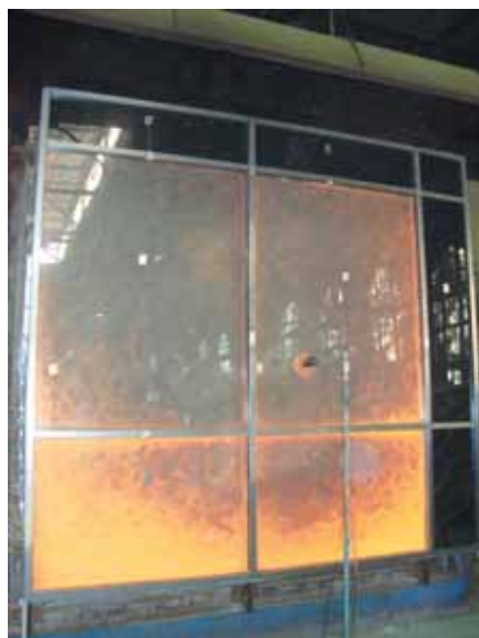
Несущая навесная светопрозрачная конструкция (фасад) с каркасом из стальных профилей и заполнением из пожаростойкого стекла в составе стеклопакета.
