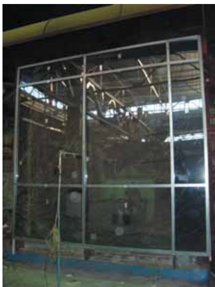
Несущая навесная светопрозрачная конструкция (фасад) с каркасом из стальных профилей и заполнением из пожаростойкого стекла в составе стеклопакета.
