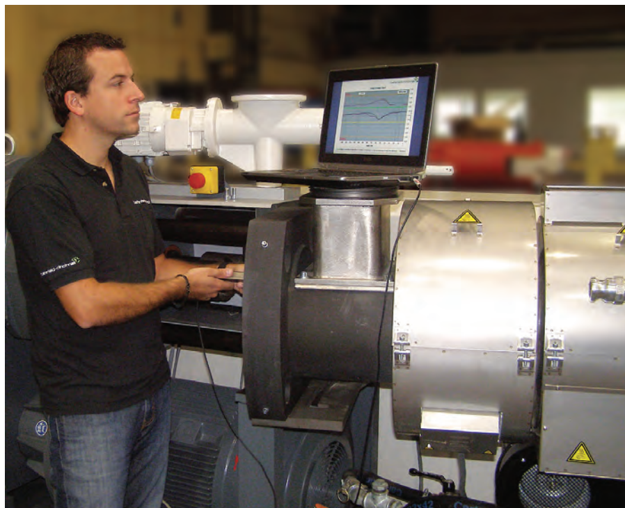
Измерение конического цилиндра в рамках инспектирования износа компанией battenfeld-cincinnati
