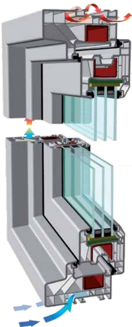
Устройство дышащего окна. Воздух поступает по теплоизолированному воздуховоду длиной от 2,7 м, постепенно прогреваясь
