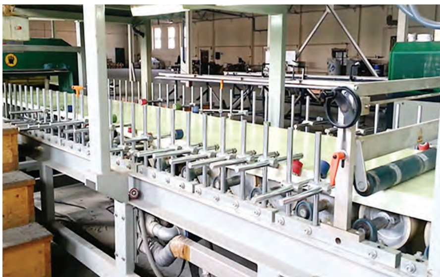
Рис. 4. Процесс ламинирования подоконных досок
