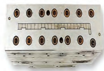
Рис. 3. Фильера для экструзии подоконной доски
