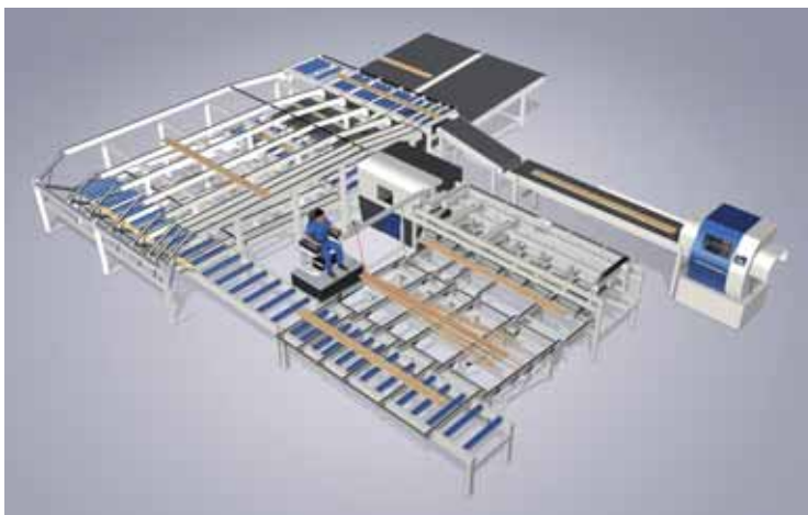
Повышение ценности материала: система оптимизации по ширине Weinig обеспечивает максимальный выход готовой продукции
