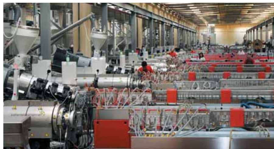
Производственный цех компании Profilink с работающими экструзионными линиями «battenfeld-cincinnati» и «Greiner Extrusion» © Profilink
