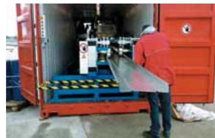
Рис. 12. Профилирование полос на мобильной установке формования
