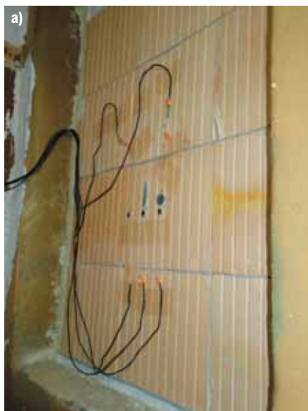
Рис. 5. Внешний вид фрагментов стен (см. рис. 4а, рис. 4б) для исследования влажностного режима минераловатного утеплителя с установленным термодатчиком на внутренней поверхности.
