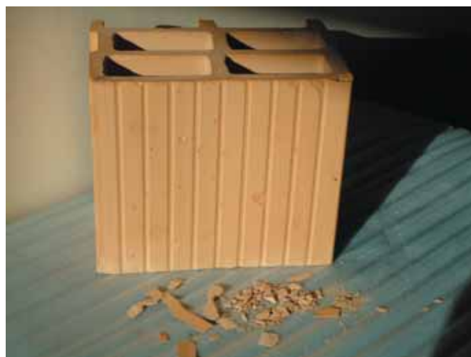
Рис.2. Внешний вид керамической части блока после 17-го цикла замораживания – оттаивания.
