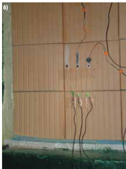
Рис. 5. Внешний вид фрагментов стен (см. рис. 4а, рис. 4б) для исследования влажностного режима минераловатного утеплителя с установленным термодатчиком на внутренней поверхности.
