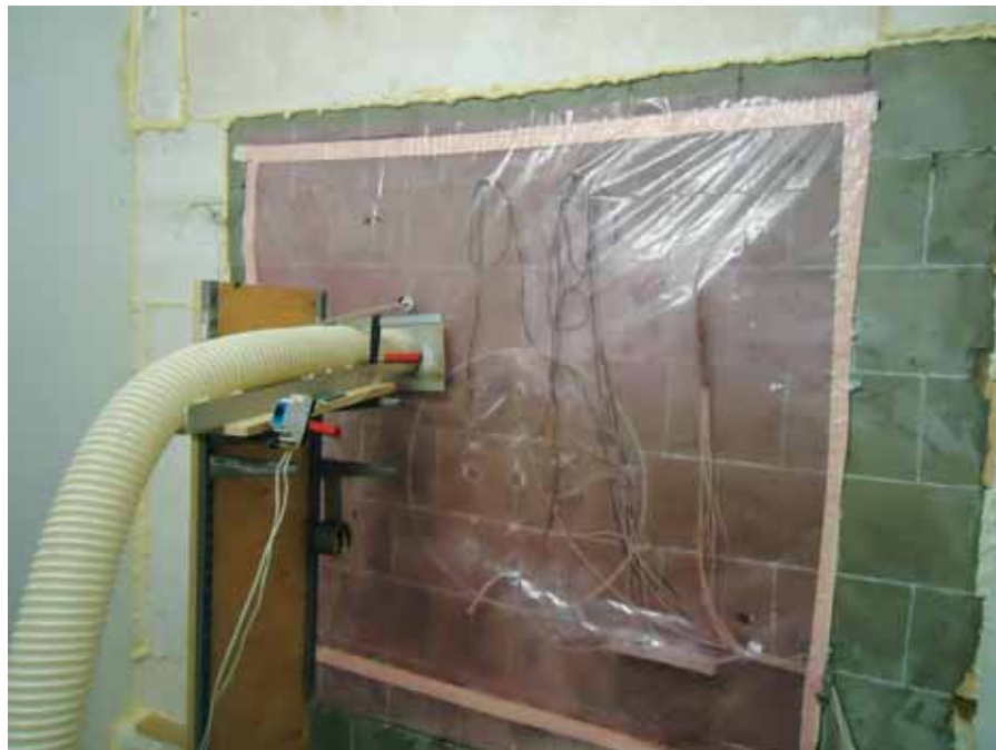
Рис.6. Устройство для испытания фрагмента стены на воздухопроницаемость.
