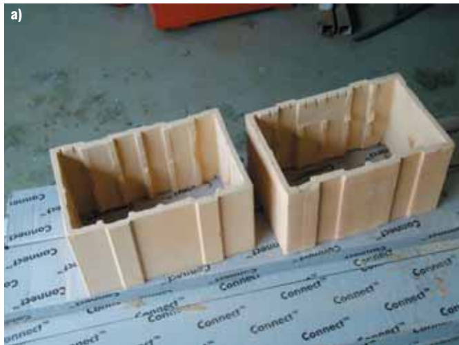
Рис. 4. Внешний вид крупноформатных керамических блоков с удаленными внутренними керамическими стенками (а) и заполненными минераловатным утеплителем (б).
