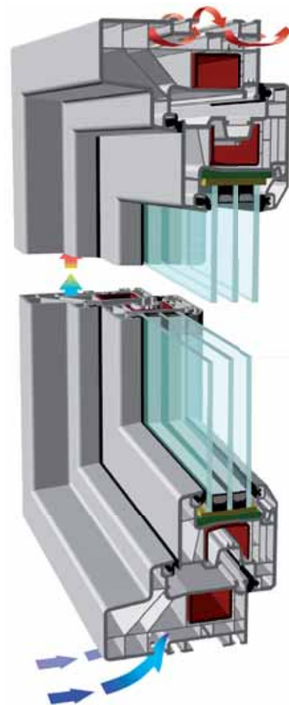
Схема работы внутрпрофильного доступа приточного воздуха в окнах EXPROF Aero:
