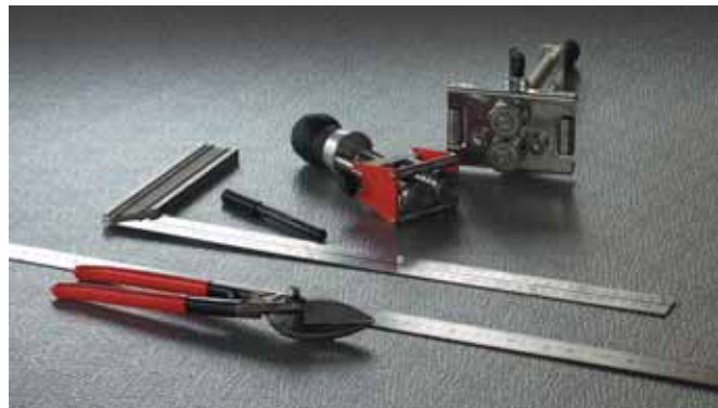
Специальные инструменты для разметки и резки рулонного алюминия, а также производства цикла работ по профилированию металла
