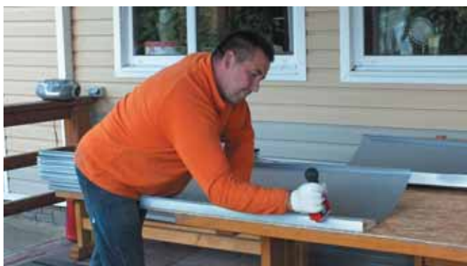
Ручное профилирование фальцевой картины с применением роликового листогиба WUKO
