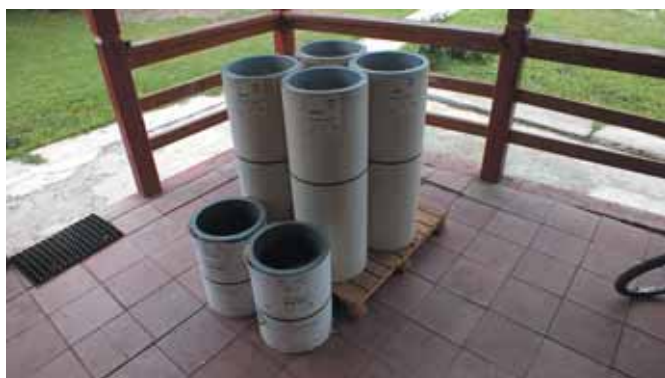
Штрипс алюминия с шириной 500 (вес 31 кг) и 1000 мм (вес 60 кг) при толщине 0.7 мм был привезен на объект в небольших бухтах
