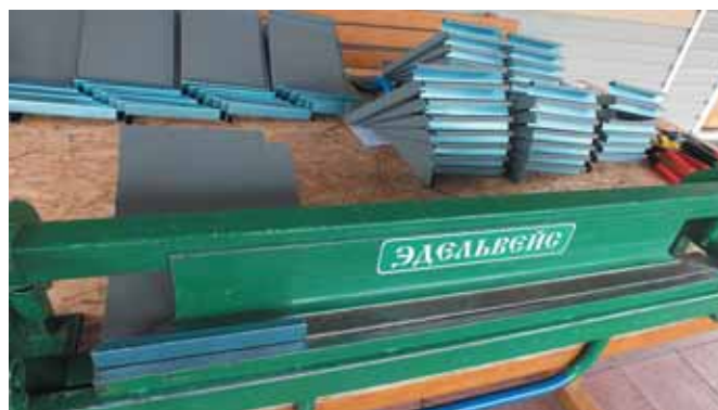
Изготовление декоративных ветровых элементов в технике Г-образного стоячего фальца
