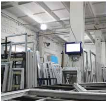
Рабочее место по сборке рамы с терминалом WH Net
