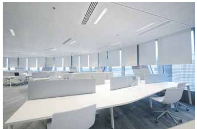
Серж Феррари полностью оборудовал высотное здание башни D2 в La Defense недалеко от Парижа внутренними солнцезащитными экранами площадью 15000 квадратных метров, со специальным покрытием Soltis 99 Low E. Это специальное покрытие уменьшающее тепловыделение внутрь помещения
