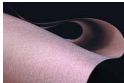
Ультратонкий алюминиевый слой на ткани Verosol демонстрирует отличные отражающие свойства, при этом обеспечивает превосходный вид снаружи и создавая улучшенный климат в помещении
