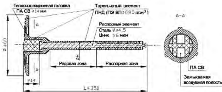
Рис. 1. Пример анкера с тарельчатым дюбелем
