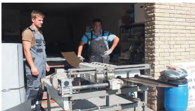
Технологический процесс изготовления фальцевых картин на станке с электроприводом (общий вид от заготовки до готового изделия) на территории подведомственного объекта
