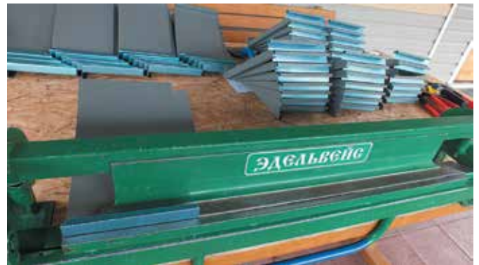
Изготовление декоративных ветровых элементов в технике Г-образного стоячего фальца
