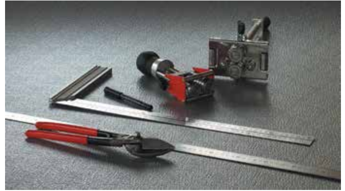
Специальные инструменты для разметки и резки рулонного алюминия, а также производства цикла работ по профилированию металла
