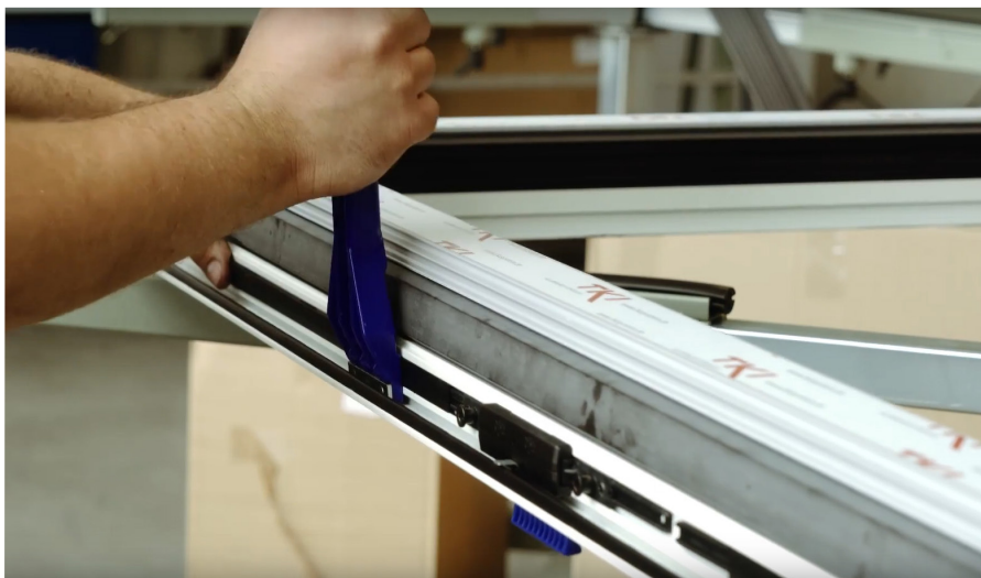
Фурнитура aluPilot устанавливается в фурнитурном пазу с помощью специальной монтажной лопатки
