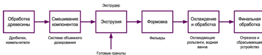
Рис. 12. Технологическая схема производства ДПК-профилей (в вариантах используемого сырья в виде компаунда или в виде гранул)
