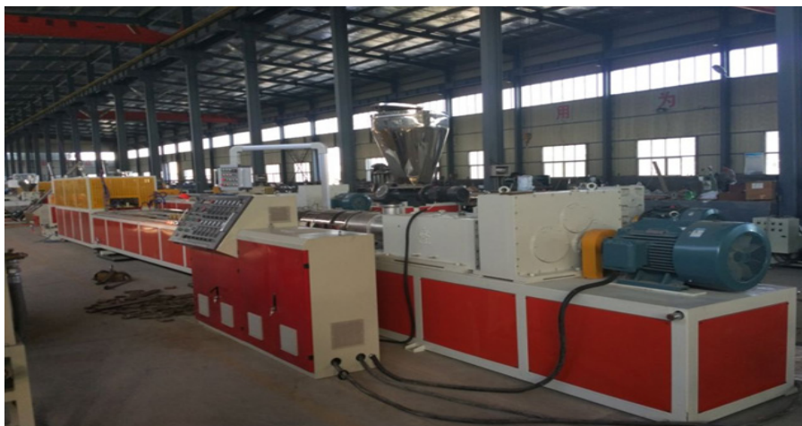
Рис. 11. Линия производства ДПК-профилей
