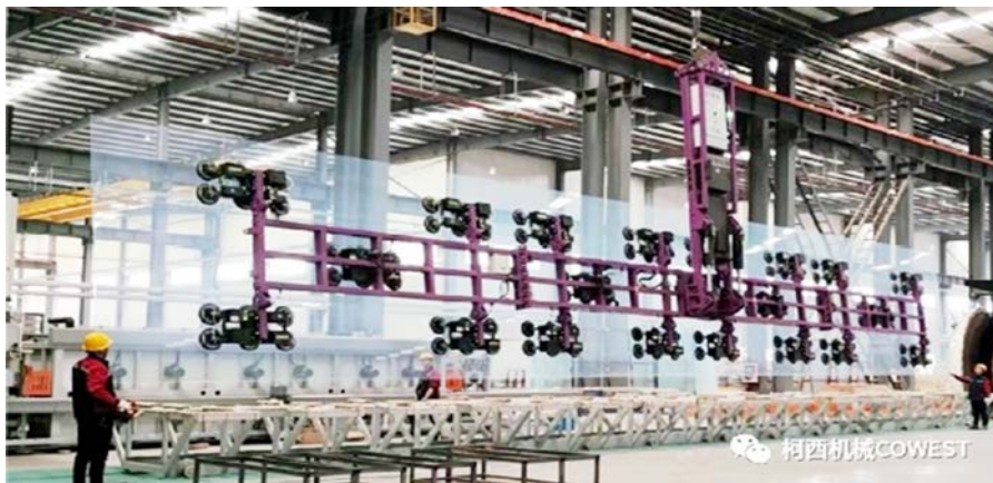
Самая большая в мире цельностеклянная панель длиной 20 метров и шириной 3,3 метра, разработанная и изготовленная компанией Haojing Group
