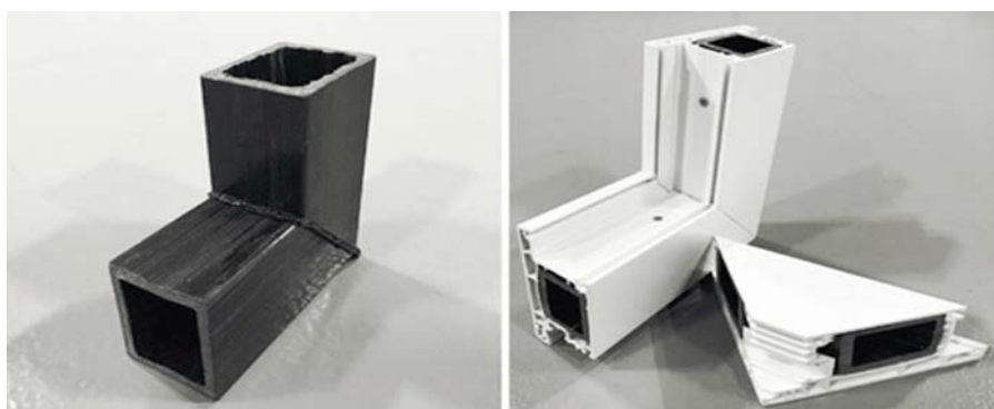
Рис. 4. Сваренный углом профиль (квадратная труба) из армированного стекловолокном термопластичного полимера (слева), изготовленная исследователями «Сколтеха» для демонстрации возможности применения такого рода деталей в качестве замены стальных армирующих элементов для окон из ПВХ-профилей (справа). Источник: Кирилл Минченков и другие / Materials & Design
